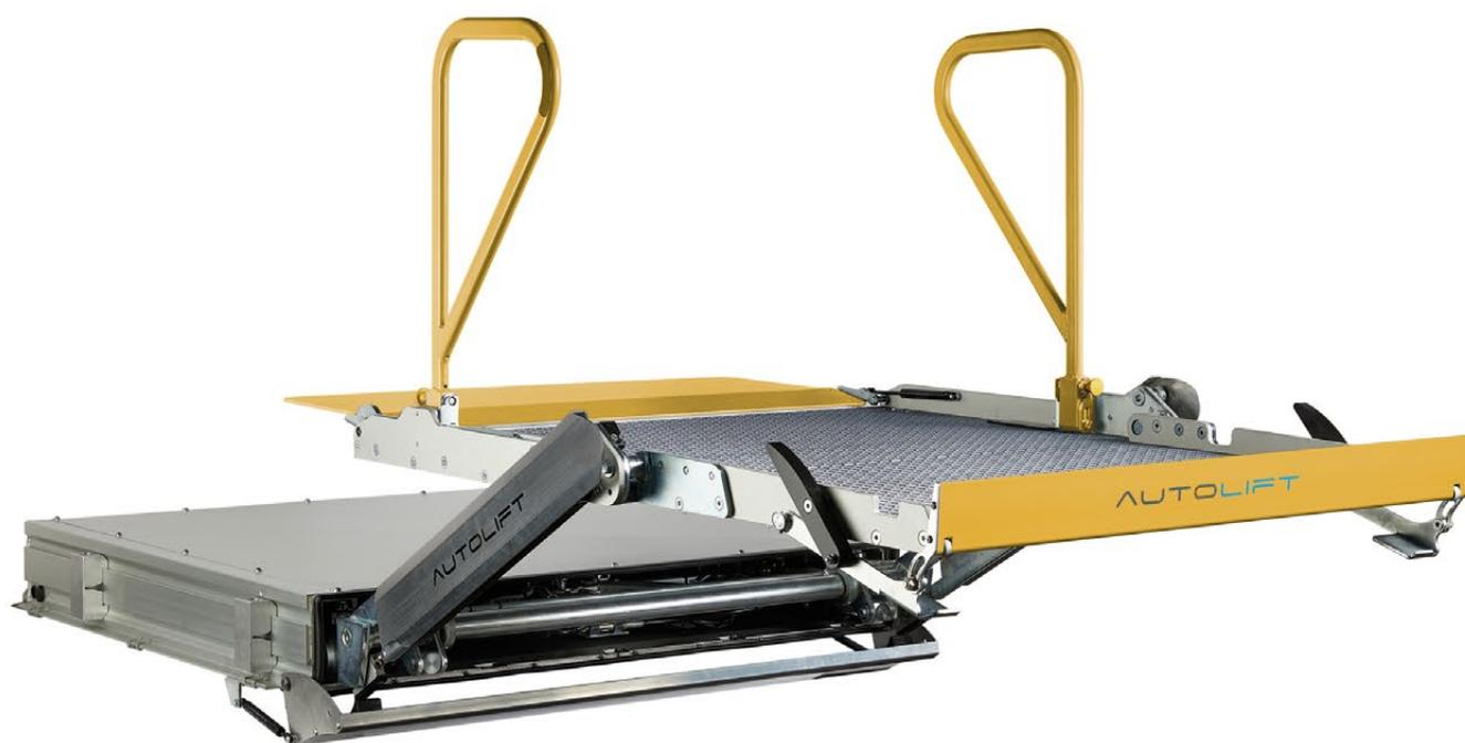
**SP 1100A** è un sollevatore semiautomatico retrattile a scomparsa, da installare posteriormente o lateralmente sotto il telaio del veicolo.
