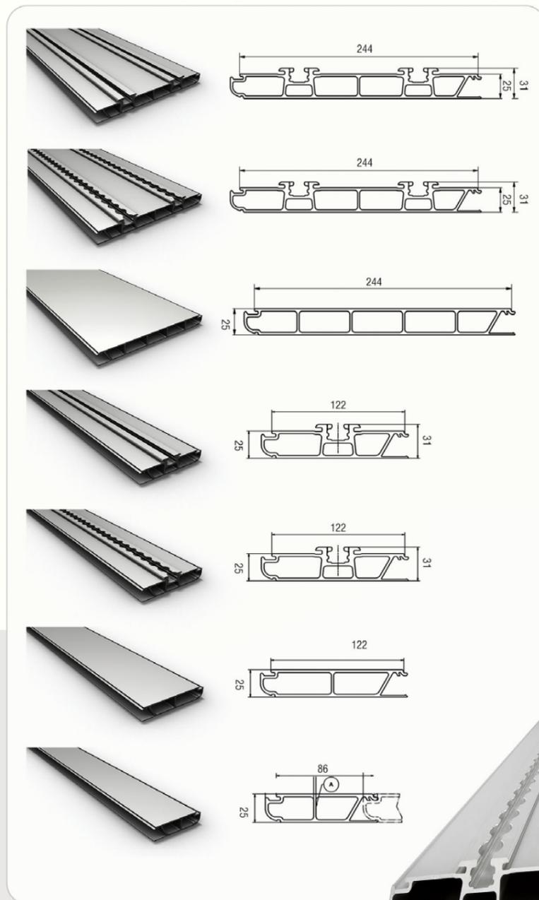
Il pianale ALUFLOOR è un sistema innovativo costituito da profili estrusi di alluminio uniti tra loro a pressione. Una volta ottenuto il pavimento con la configurazione richiesta, andrà semplicemente incollato al piano del veicolo.
