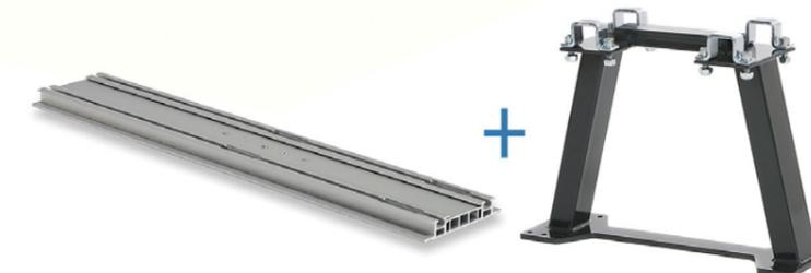
Il pianale RAIL-IN è un pianale misto dal sistema innovativo. E' costituito dall'unione di profili in alluminio estrusi e parti composite o di legno incollati al veicolo. Tale soluzione, utilizzando i profili in alluminio solo dove si avranno i fissaggi e gli scorrimenti, rispetto a quelle in alluminio tradizionali, si presenta più leggera ed economica.
