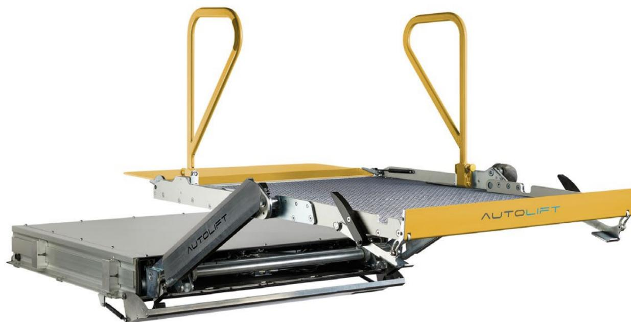
**SP 1100A** è un sollevatore semiautomatico retrattile a scomparsa, da installare posteriormente o lateralmente sotto il telaio del veicolo. Grazie al dimensionamento dei bracci, la pedana può essere posizionata anche in prossimità delle porte dedicate senza gradino di salita. Il cassetto del sollevatore **SP 1100A** è realizzato in alluminio estruso, con dimensioni contenute che consentono l'installazione su una gamma di veicoli M1-M2 particolarmente ampia.
